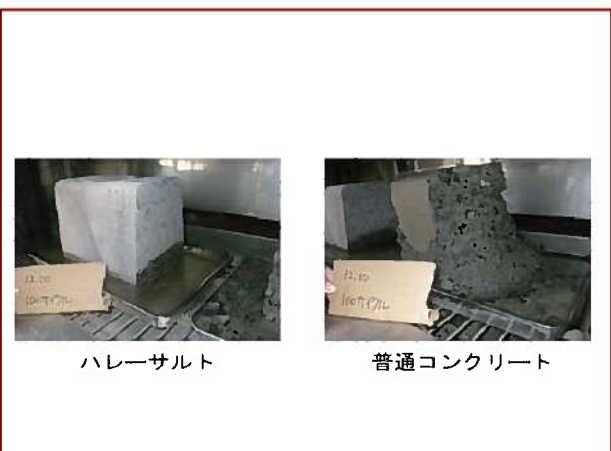
塩害と凍害の複合劣化による凍結融解試験
