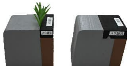
写真1：左側は従来工法 右側は雑草防止工法
