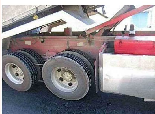
散布直後にタンクが進入した状況(タイヤの汚れ無し)
